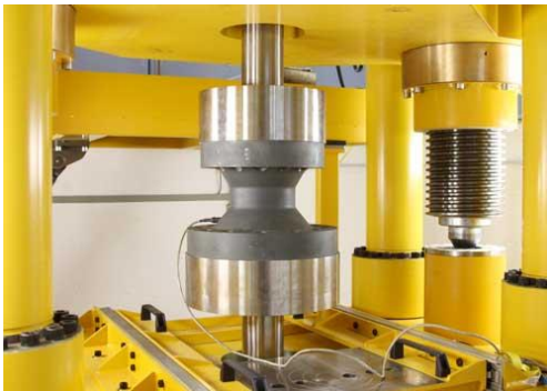
Bild 2: Zugkraftkalibrierung 3 MN mit laboreigenen Zugstäben
